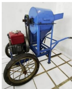
Gambar 1. Prototipe Mesin Pencacah Pelepah dan Daun Kelapa Sawit Sumber gambar: Dokumen pribadi
