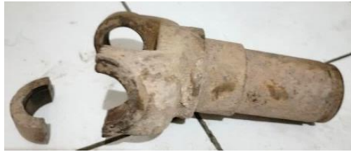
Gambar 2. Bagian salah satu lengan slip yoke mengalami patahan
