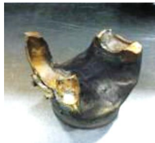
Gambar 3. Kegagalan lain berupa deformasi atau pembengkokan dan patah pada slip yoke (Tathe & Bajaj).
