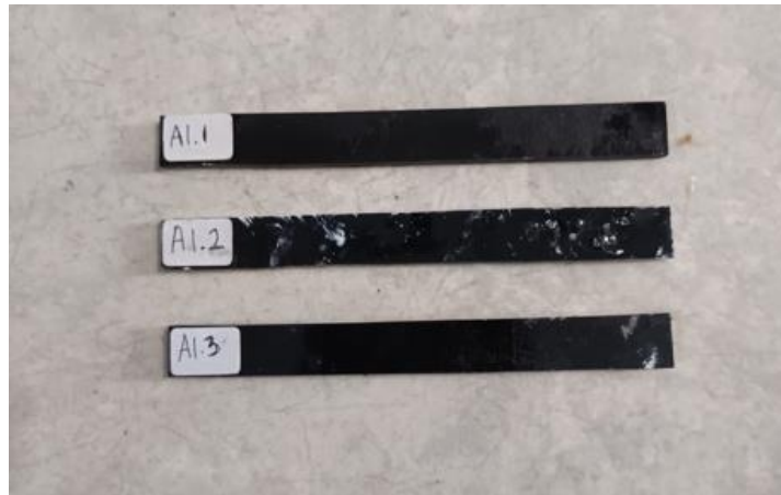
Gambar 3. Spesimen uji flexural
