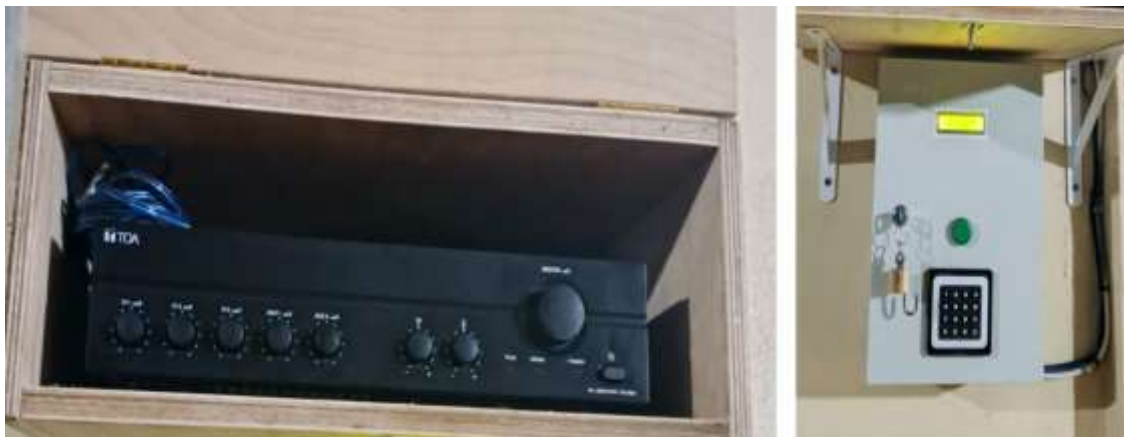
Gambar 2. Panel kontrol (keypad dan LCD) serta amplifier yang ditempatkan pada rak pelindung.
